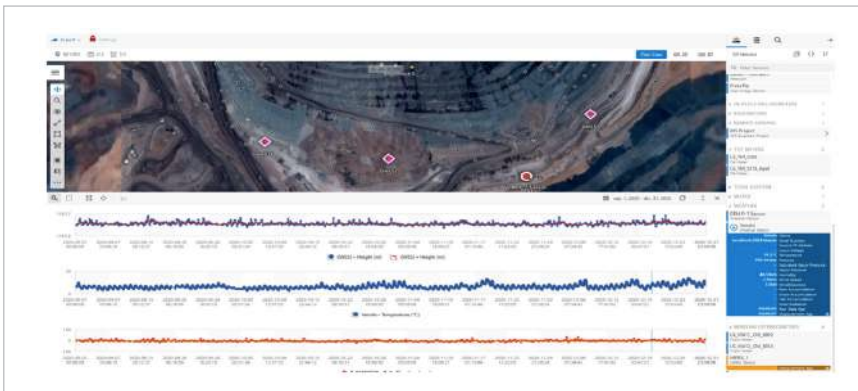
Figura 1. Ejemplo de visualización de la plataforma de vigilancia Hexagon GeoMonitoring Hub. Fuente Leica Geosystems.
